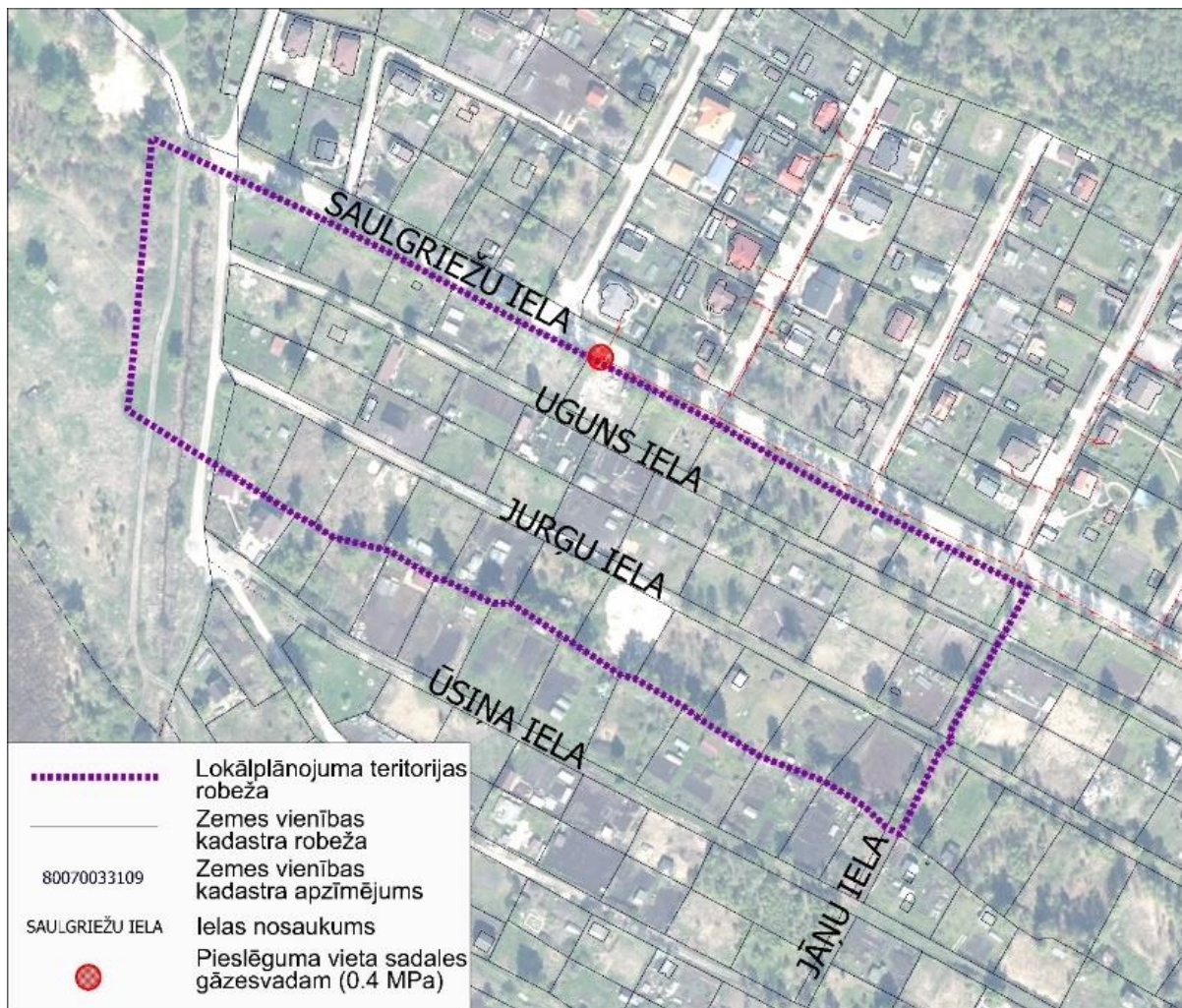
7.att. Pieslēguma vieta sadales gāzesvadam
